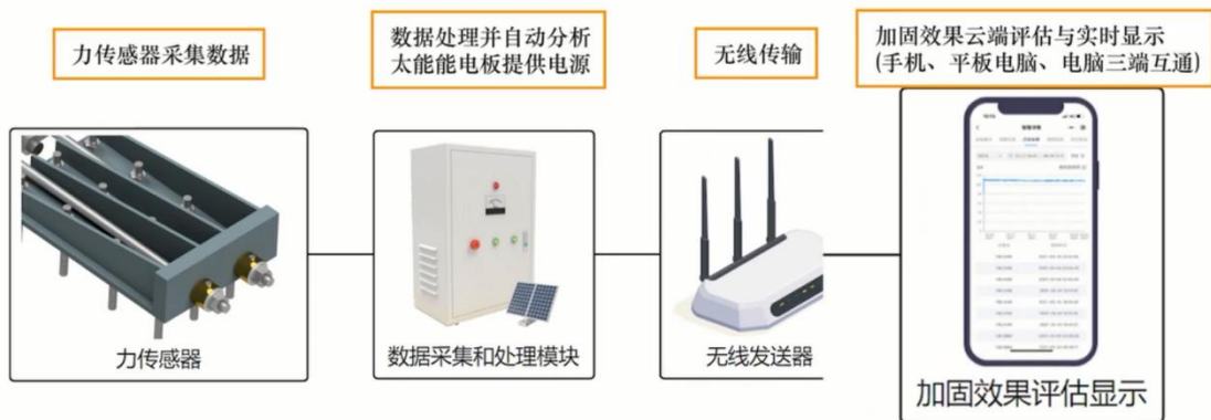
图3 预应力碳纤维筋加固技术加固效果无线智能监测技术
